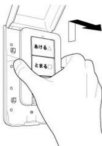
ワイヤレス押しボタンスイッチを上をスライドして、スイッチボックスから取り外します。
