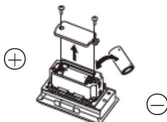
裏面の電池フタのねじを2ヶ所外してフタを開け、新しい電池と入れ替えます。
