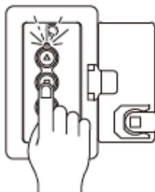
電池容量が低下すると、「開」「停」「閉」いずれかのスイッチを押している間、ボタン上部の送信ランプが点滅します。
