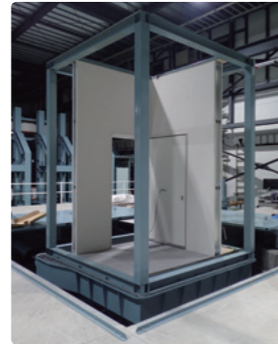
耐震防火戸「アスコード」耐震試験の様子
